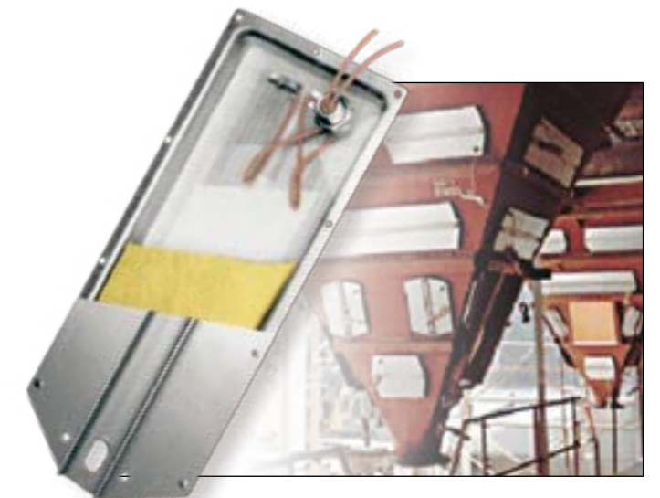
Обогрев бункеров и желобов Температура поддержания ... до 427°C Максимальная температура воздействия ... 538°C Максимальная удельная мощность ... 4650 Вт/м² Напряжение питания ... 120–600 В (~)
