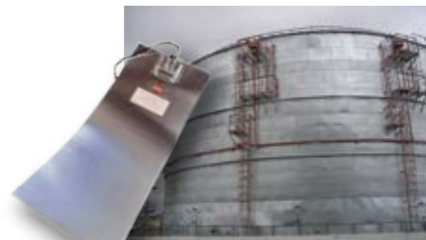
Обогрев емкостей и резервуаров Номинальная мощность ... 500, 1000, 2000 Вт Максимальная температура поддержания ... 121°C Максимальная температура воздействия ... 538°C Напряжение питания ... 120–2400 В (~)
